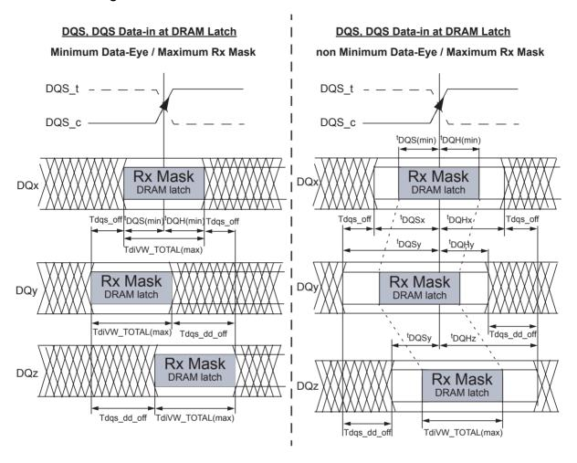
NOTE: DQx represents an optimally centered input DQy represents earliest valid transitioning input DQz represents latest valid transitioning input
