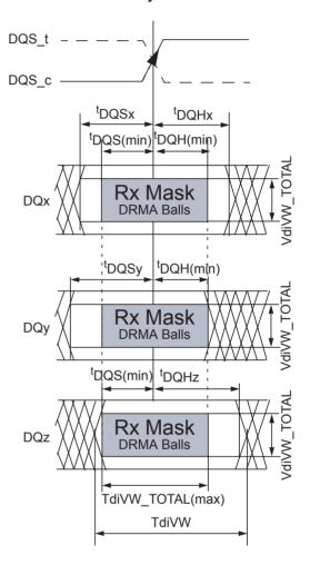
NOTE: DQx represents an optimally centered input DQy represents earliest valid transitioning input DQz represents latest valid transitioning input
