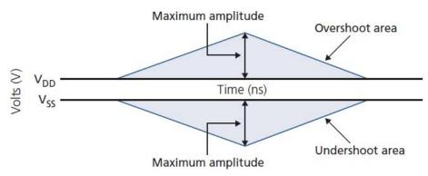
Notes: 1. VDD stands for VDDCA for CA[9:0], CK, CK#, CS#, and CKE. VDD stands for VDDQ for DQ, DM, DQS, and DQS#.
